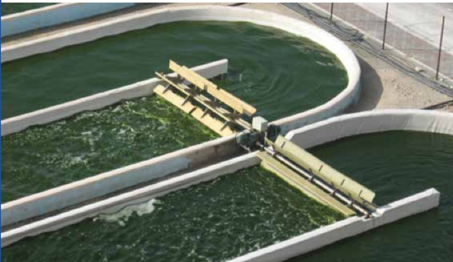
Système de culture de microalgues Raceway
