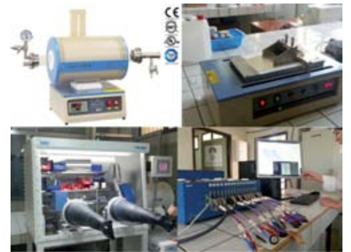
Figure 7: Quelques équipements nécessaires pour une R&D en batteries lithium-ion (Four pour la synthèse, 'Doctor Blade' pour la préparation des électrodes en couches minces, Cycleur de batteries 16 voies; Boîte à gants sous argon pour le montage des batteries)
